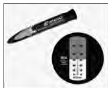
図5：アナログ式糖度計 ⇒ 小窓をのぞいてBrix値を確認します
