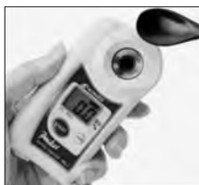
図4：デジタル式糖度計 ⇒ 3秒でBrix値が表示されます
